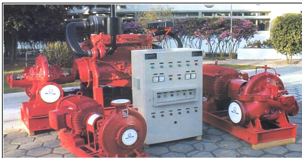
GRUPO MOTO BOMBA KSB DIESEL, GASOLINA E ELÉTRICO PARA COMBATE A INCÊNDIO CONFORME NORMA NFPA 20 / NBR 10897
